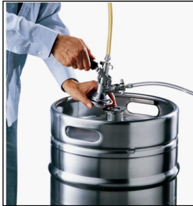
Abb. 31 Fass - Zapfkopf montieren
