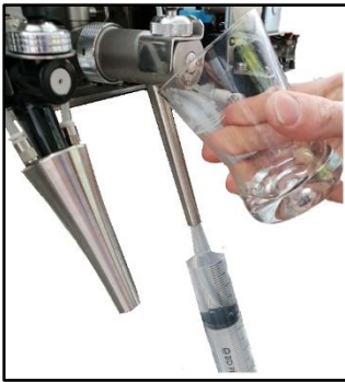
Abb. 55 Bier pneumatisch - Reinigung mit Reinigungsspritze
