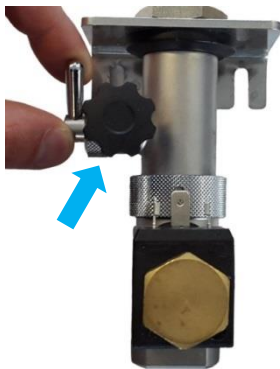
Abb. 45 Fließgeschwindigkeit - elektrischer Hahn
