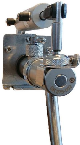
Abb. 44 Fließgeschwindigkeit - pneumatischer Hahn
