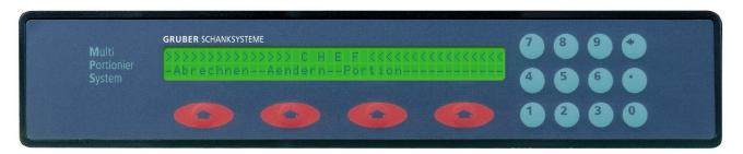
Die Menüpunkte **ABRECHNEN**, **AENDERN** und **PORTION** wählen Sie durch die unterhalb liegenden roten Tasten aus.
